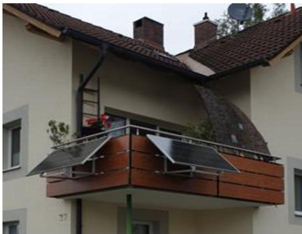
*Diese Aufnahme zeigt ein Balkonkraftwerk, das nach einer Beratung vom Mieter selbst aufgebaut wurde. Die Herausforderung bestand darin, die Kunststoffbretter des Balkons und die Unterkonstruktion dabei nicht zu beschädigen.*
